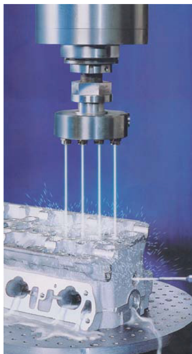
Entgraten durch Hochdruckwasserstrahlen
